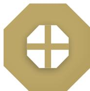
*Buen agarre del instrumento de inserción debido a la cabeza octogonal que ofrece más superficie de contacto*
